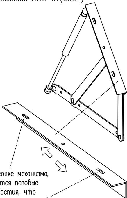
на уголке механизма, имеются пазовые отверстия, что позволяет регулировать сиденье по горизонтали.
